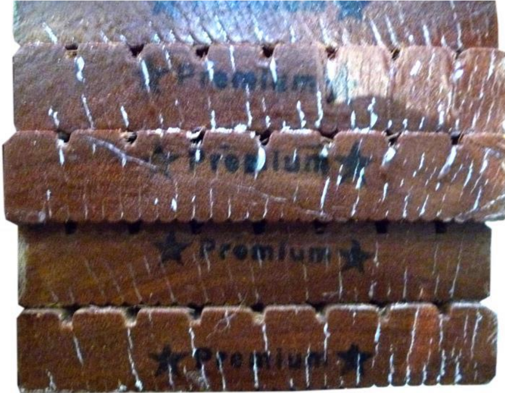
Harthölzer mit werkseitig aufgetragenen Hirnholzschutz
